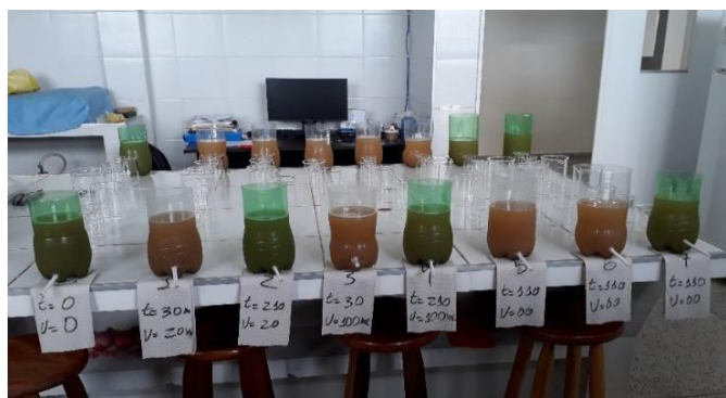
Figura 3 – Ensaios de tratamento das amostras de 1 L de água, obtidas no processo de lavagem de automóveis.
